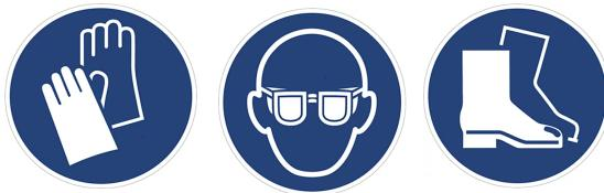
Durante gli interventi sugli impianti di refrigerazione è necessario indossare un equipaggiamento protettivo adeguato, come guanti, occhiali di sicurezza e calzature di protezione.
