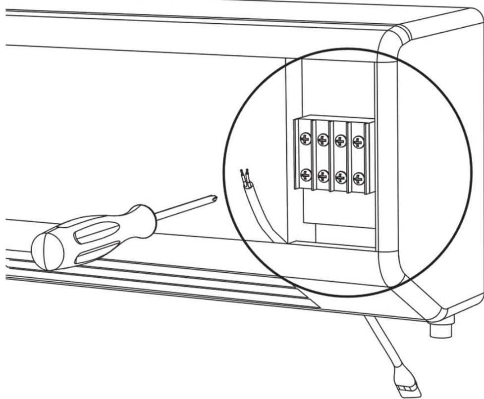
Opcionalmente, los cables gris y violeta pueden conectarse para controlar la alimentación de la unidad interior. Esto permitirá que la bomba desactive la unidad en caso de que se genere demasiada agua para la capacidad de la bomba.
