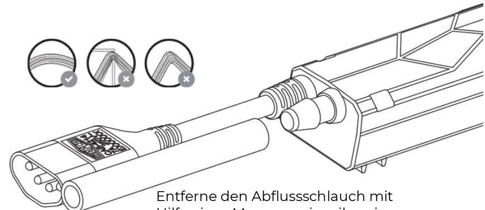
Entferne den Abflussschlauch mit Hilfe eines Messers, reisse ihn nie raus. Zu hohe Kräfte auf Pumpe können Schäden verursachen.
