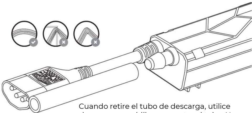
Cuando retire el tubo de descarga, utilice siempre un cuchillo para cortar el tubo. Una fuerza excesiva puede destruir la bomba.
