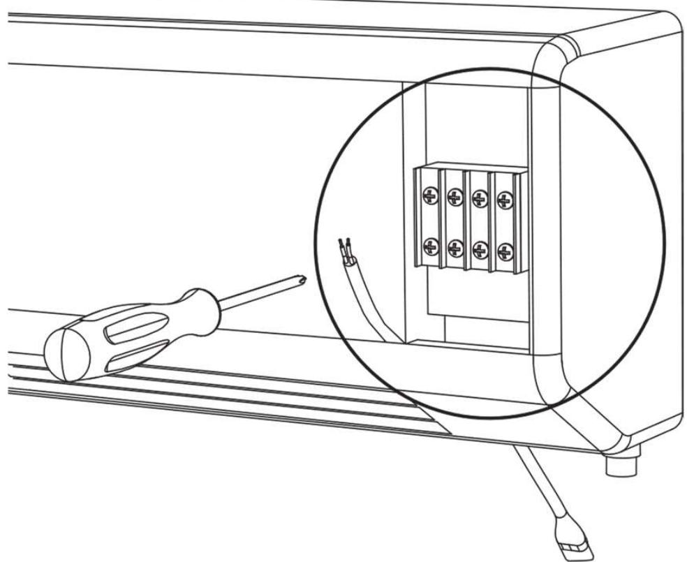
Opzionalmente, i fili grigio e viola possono essere collegati per commutare l'alimentazione dell'unità interna. Ciò consente alla pompa di disattivare l'unità nel caso in cui venga generata una quantità d'acqua eccessiva rispetto a quella che la pompa è in grado di gestire.
