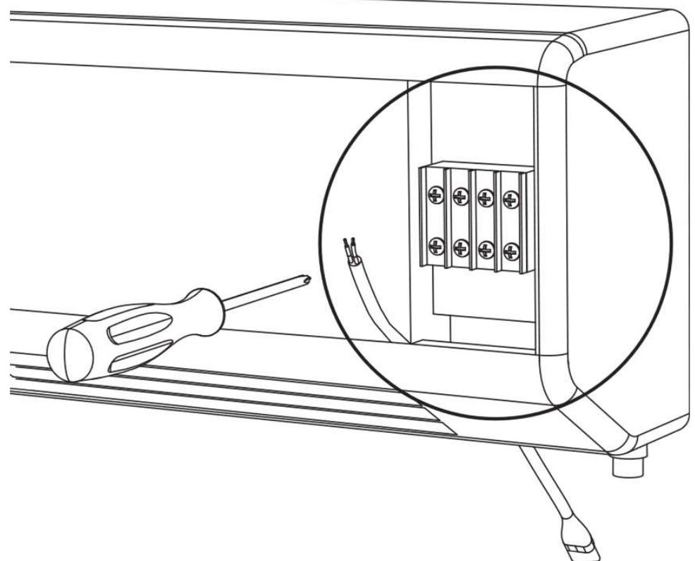
Optional können die grauen und violetten Litzen angeschlossen werden, um die Stromversorgung des Innengeräts zu schalten. Dies ermöglicht es der Pumpe, das Innengerät zu deaktivieren, wenn mehr Wasser erzeugt wird, als dass die Pumpe es bewältigen könnte.
