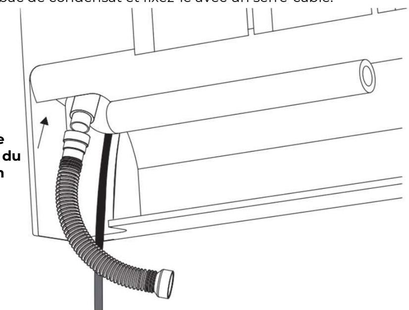
8.4 Raccordement de la pompe au tuyau flexible et extensible.
