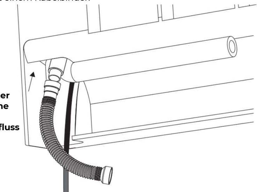
8.4 Pumpe an den ausziehbaren Flexschlauch anschliessen
