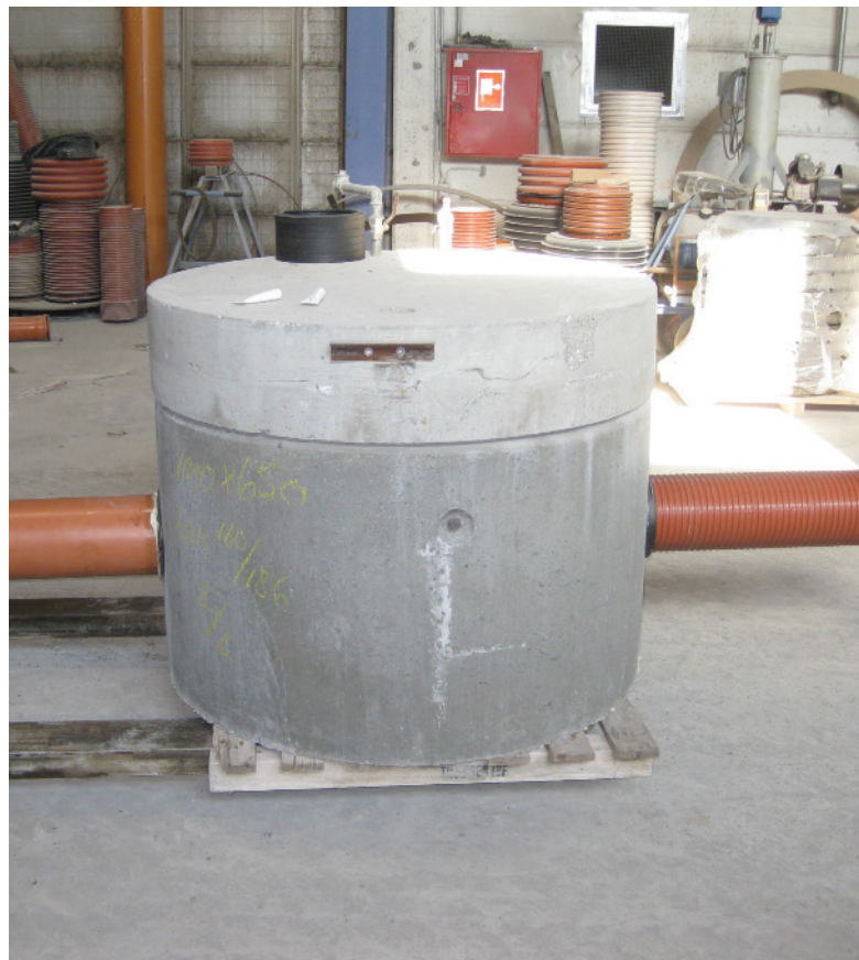
Brunn med anbörningar, klar för provning
