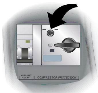
Bild 17. Utför kalibreringen med hjälp av justerings skruven på framsidan av motorskydds brytaren.
